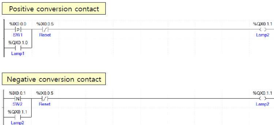
Positive conversion contact – Pozitiv çevrilmə kontaktı
