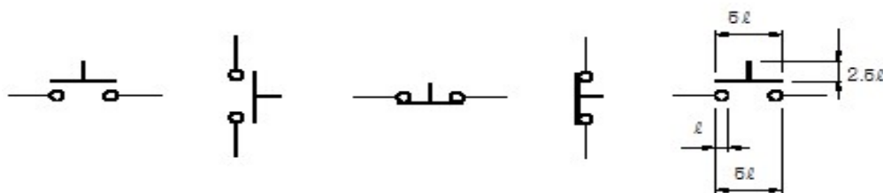
(a) Kontakt "a" (b) kontakt "b" (c) qurulma metodu (Şəkil 2) Təkan düyməsi kontaktlarının qrafik simvol və qurulma metodları
